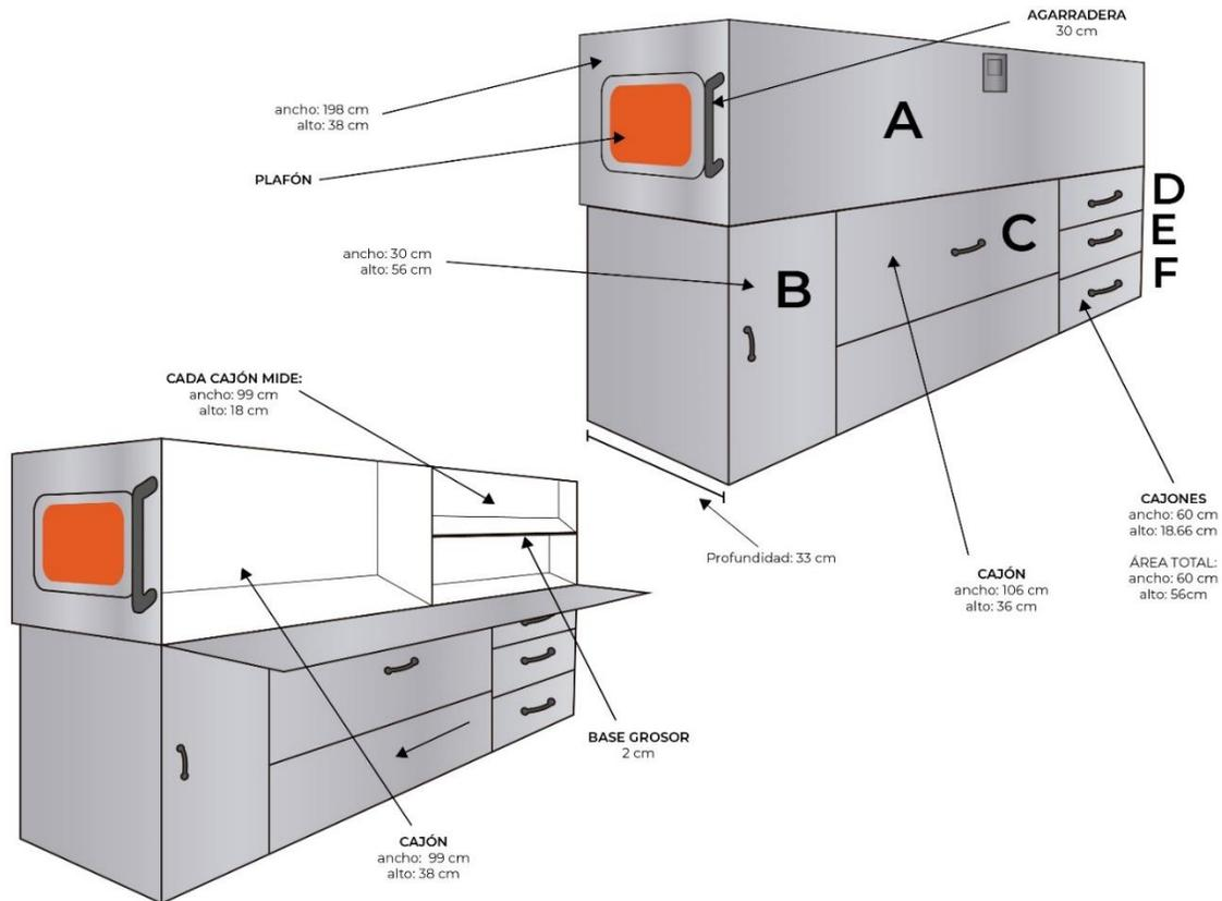
La estructura de la caja de herramientas lateral ubicada en el costado izquierdo de la batea, estará dividida en 6 compartimientos, los cuales abrirán al interior de la batea de la unidad (A, B, C, D, E y F), todas con manija y chapa de alta durabilidad, se sustentan por medio de cables de acero y llevan un contramarco de goma anti ruido para evitar vibraciones, terminadas en color aluminio.
