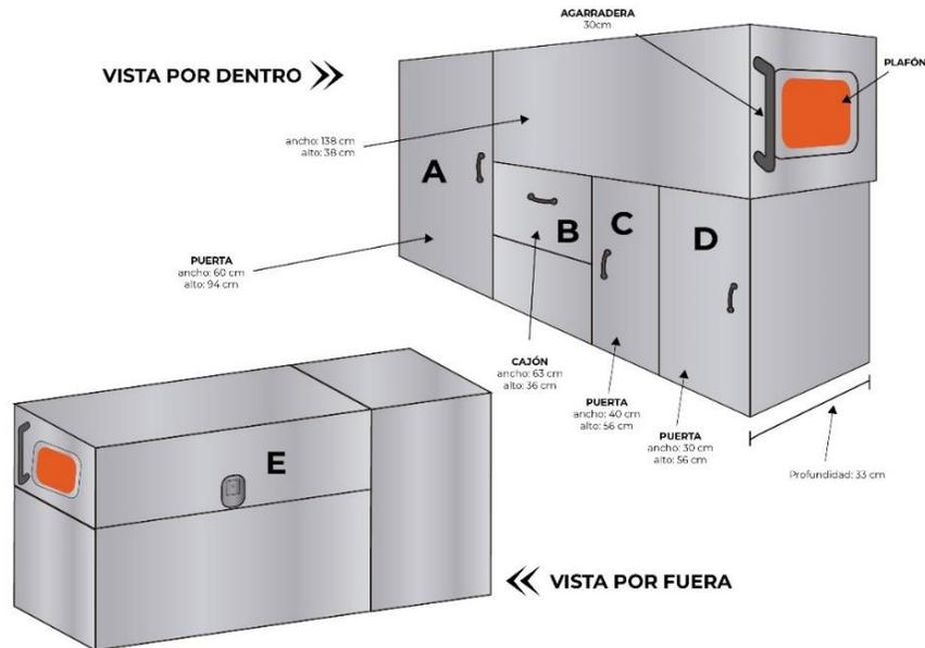
La estructura de la caja de herramientas lateral ubicada en el costado derecho de la batea, estará dividida en cuatro compartimientos que abrirán al interior de la batea de la unidad (A, B, C, D) y un compartimiento superior que abrirá hacia afuera (E), todas con manija y chapa de alta durabilidad, se sustentan por medio de cables de acero y llevan un contramarco de goma anti ruido para evitar vibraciones, terminadas en color aluminio.
